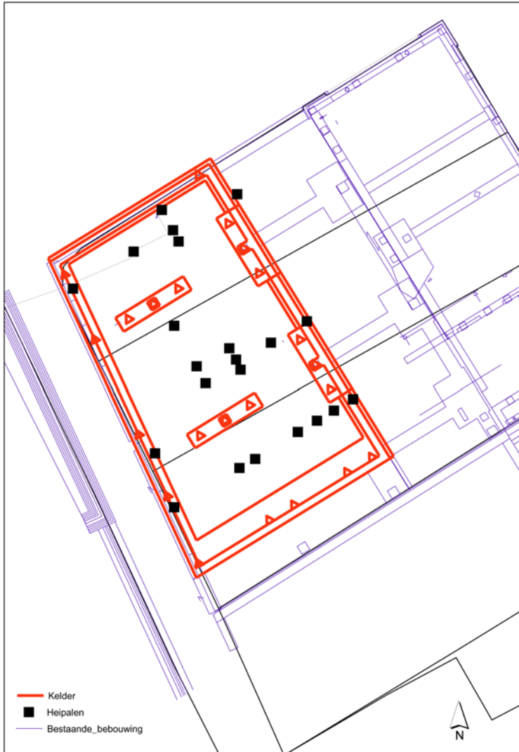
Afbeelding 4. Bouwplan met kelder (het onderzoeksgebied, rood omkaderd). Schaal: 1: 200.
