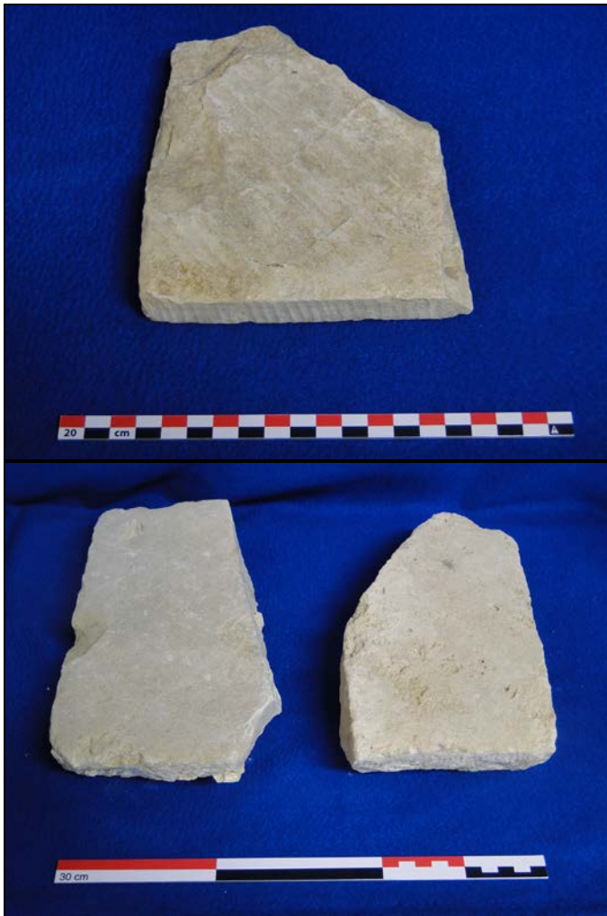
Afbeelding 61. Vloertegels van Gobertange / Ledesteen met nog zichtbare scharreerslag (boven), uitwering van het oppervlak of gladde afslijting door belopen (onder).
